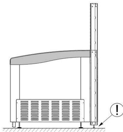
6. Установить кронштейны полок на необходимом уровне. При монтаже двухсторонней суперструктуры, дополнительно устанавливаются кронштейны с противоположной стороны стойки. Установить полки на место, в соответствии с размером кронштейнов.
