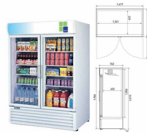
FRS-1350R • Мощность, кВт: 0,555 • Объем, л : 1315 • Температурный режим : 0° ~ +8° • Кол-во полок : 8 • Вес, кг : 226 • Габариты, ш/г/в (мм) : 1417x813x2015
