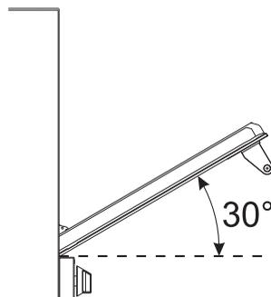
Для повторной установки вставить петли в специальные отверстия, имеющиеся в духовке, убедившись в том, что желобки **С** прислоняются полностью на отверстия. Опустить дверцу вниз и после ее установки вынуть стержни из отверстий петель.
