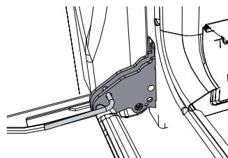
Взять дверцу за обе стороны двумя руками рядом с петлями, приподнять ее под углом приблизительно 30° и вынуть.
