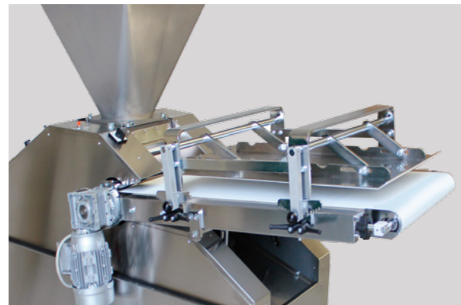
dispositivo removibile di filatura removable moulding system dispositivo removibile di filatura removable moulding system
